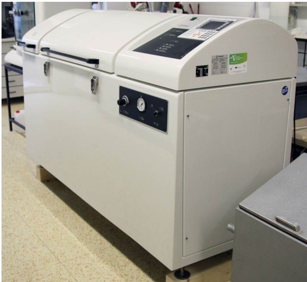
Fig. 6 Liebisch SKB 400A-TR corrosion chamber.
